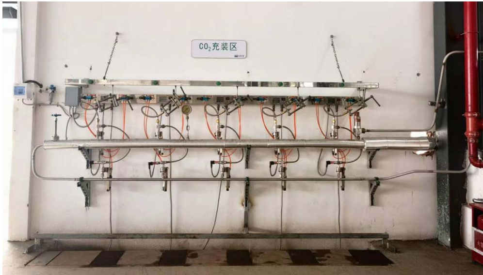
图：具有余气回收利用功能的二氧化碳自动化充装系统
