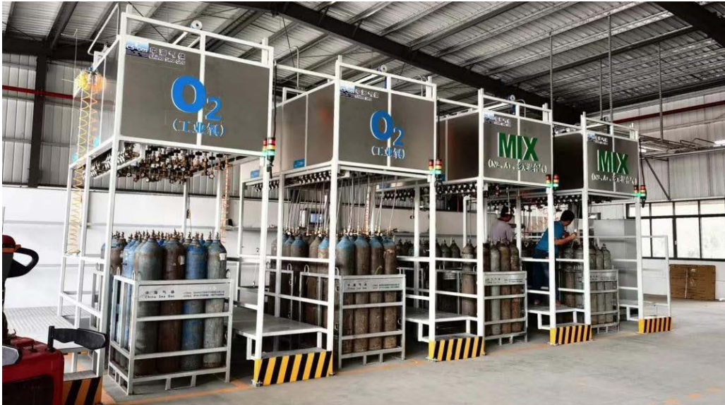
图：可远程控制的数字化花篮式自动充装
